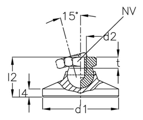
d1 = 25 d2 = 6 l2 = l4 = -NV = 12 Static load (kN) = 7.5 t min = 9
